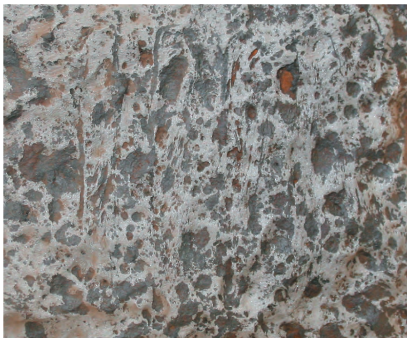
Fig. 4. Nowosiółki Kardynalskie. Traces of pattern-welded inlay on the blade. Before etching. Photo. K. Rybka
