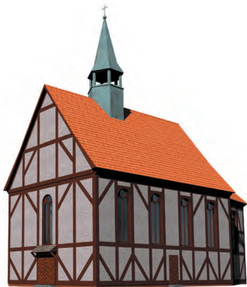
Ryc. 6. Wrocław, kościół Salwatora. Rekonstrukcja świątyni z I fazy budowlanej (1561 r.) z widoczną konstrukcją ryglową, widok północno-wschodni. Rys. Mariusz Caban
